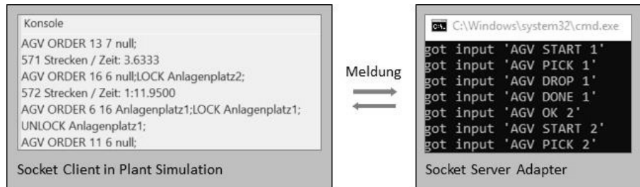
Abbildung 5: Beispiele für Kommunikationsnachrichten zwischen Modell und Adapter
